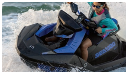
Coque Spark® La coque Spark offre une plateforme légère et amusante. Le matériel innovant Polytec MC contribue à réduire son poids sans nuire à sa performance et à son efficacité. De plus, la couleur injectée dans le matériau rend celui-ci plus résistant aux égratignures que la fibre de verre.
